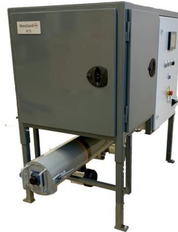
*Der R15 Saatgutbeizer ist eine Maschine die für die Aufbereitung von Saatgut, Getreide, Hülsenfrüchten, Sojabohnen, Sonnenblumen u.v.m. geeignet ist. Die Kapazität beträgt 5,4-13,5 Tonnen pro Stunde.*
