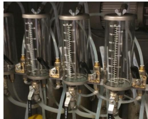
L'étalonnage du système de dosage s'effectue facilement et il est contrôlé par un système fermé.
