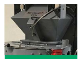
Die integrierte Waage ermöglicht es die Grösse der Charge frei zu variieren
